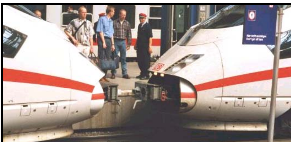
Fase de ligação de duas composições. Comboio ICE com 8+8 carruagens
