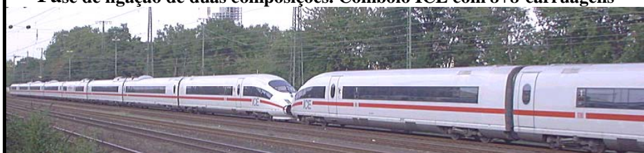
Fase de ligação de duas composições. Comboio ICE com 8+8 carruagens
